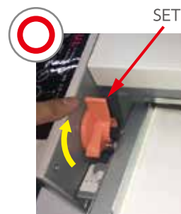
給紙セットレバーがセットの位置に 上がっていないと給紙されません
