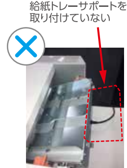
給紙トレーサポートを取り付けていないと 給紙レバーがセット位置に固定されず 給紙されません
